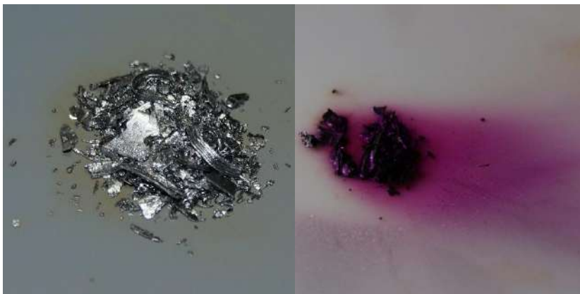
Figura 6 - Iodo cristalino puro, que sofre sublimação e se evapora em gás \text{I}_2 púrpura. Tamanho da peça maior em cm: 0.5 x 0.5
